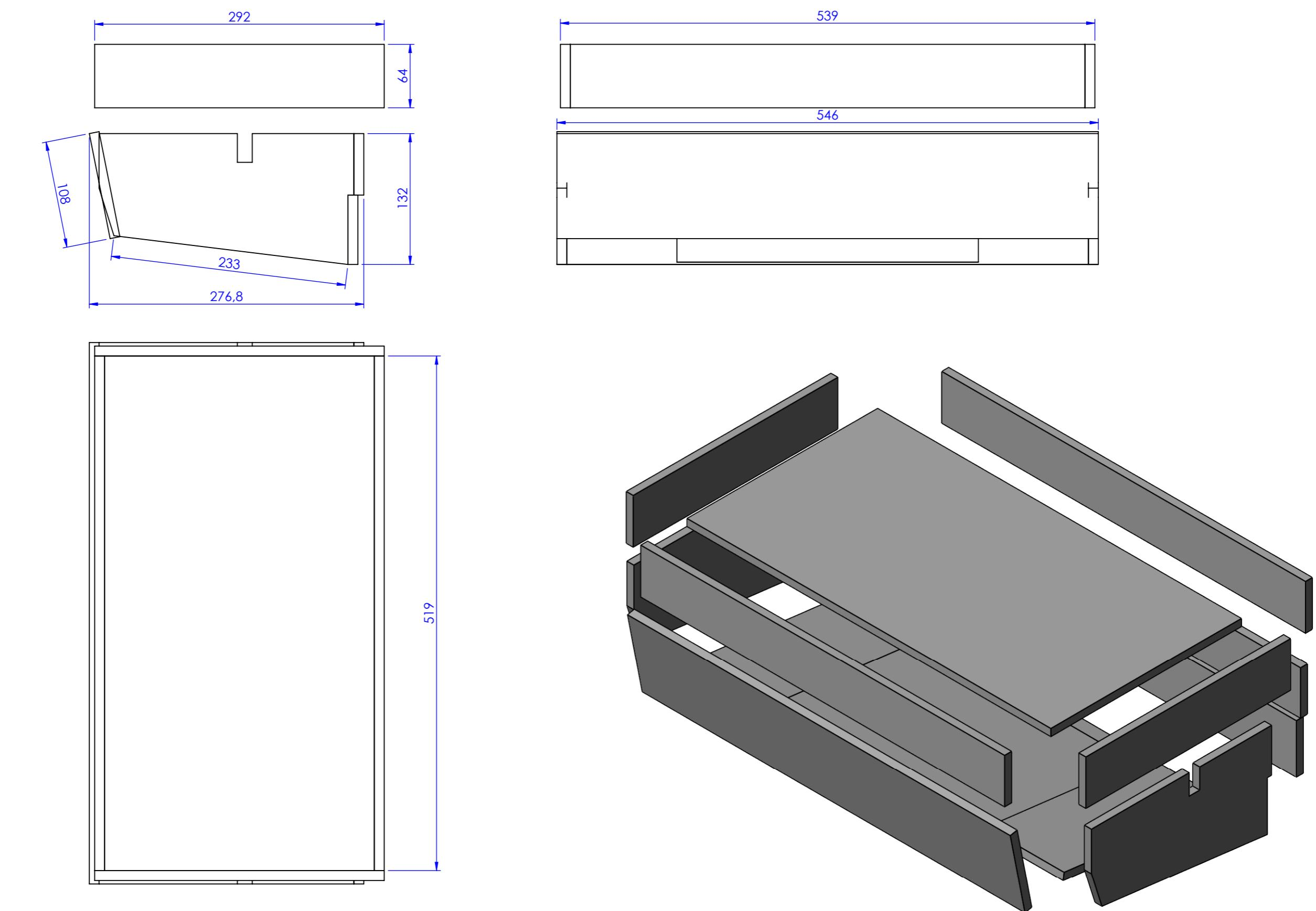
Bei der Montage ist darauf zu achten, dass die hellgraue Seite dem HF-Prüfling und die anthrazite Seite der HF-Kammer zugewandt ist.
