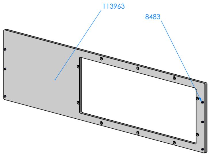
**Vor der Komplettmontage muss die Rückwand ( RWA ) mit der Schnittstelle ( SST ) verschraubt werden. Die Schnittstelle ist nicht im Lieferumfang enthalten.**
