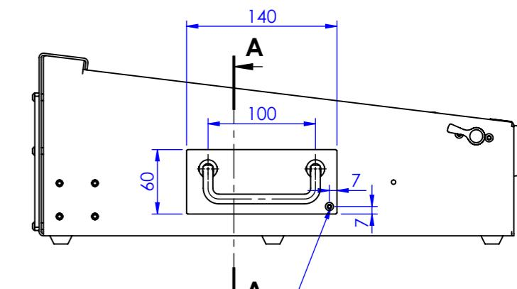
am montierten Gehäuse mit Ø3,2 abbohren
