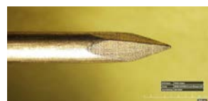
Kolbenkopfform nach 10 Einstichen
