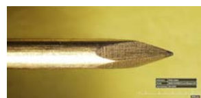
Kolbenkopfform nach 5 Einstichen
