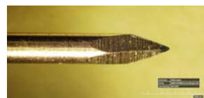
Kolbenkopfform nach 0 Einstichen
