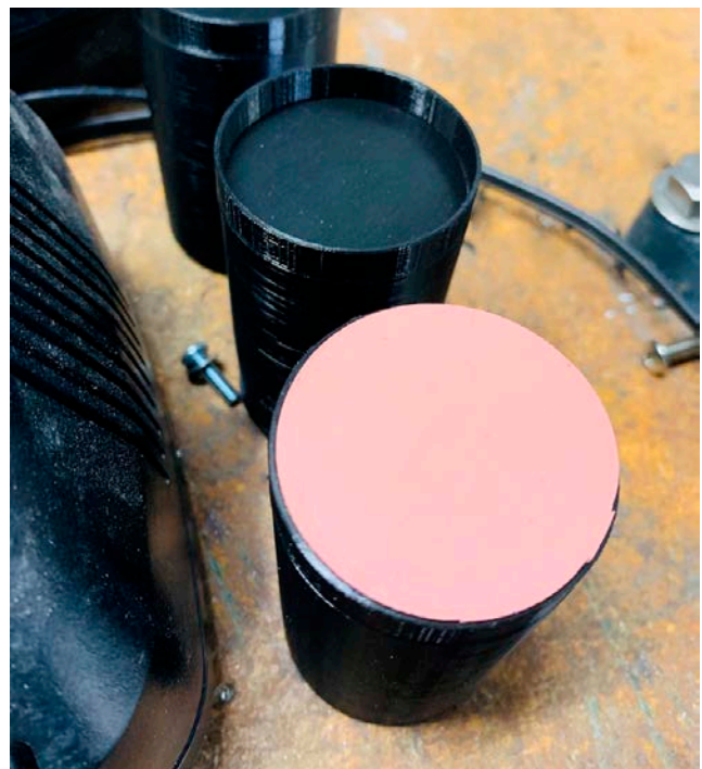
Abbildung 7: Herstellung einer In-situ-Reinigungszelle mit Kontaktreinigungsmatten (2)
