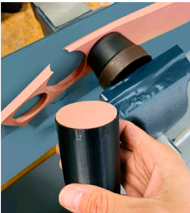
Abbildung 6: Herstellung einer In-situ-Reinigungszelle mit Kontaktreinigungsmatten (1)
