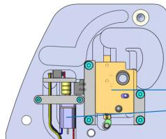
Mechanische 2-Stufen Verriegelung
