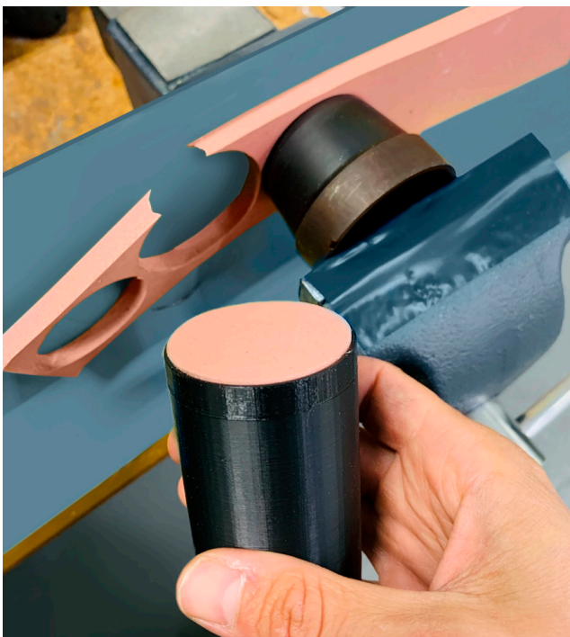
Abbildung 6: Herstellung einer In-situ-Reinigungszelle mit Kontaktreinigungsmatten (1)
