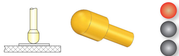
Abbildung 3: Reinigungsmatten sind für weniger aggressive Kopfformen ungeeignet.
