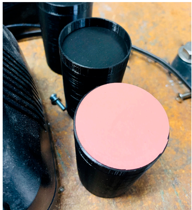
Abbildung 7: Herstellung einer In-situ-Reinigungszelle mit Kontaktreinigungsmatten (2)
