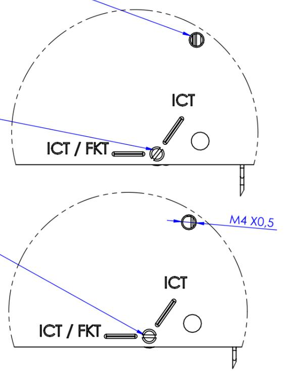
Mittels eines Schlitzschraubendrehers kann die Zwei Stufen Funktion ein bzw. ausgeschaltet werden.
