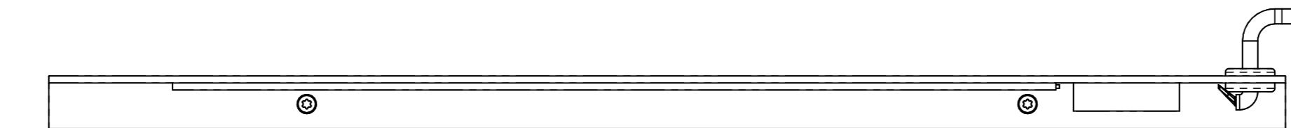
Bei Verwendung der FB-LED-D-MAXx12 (Gut/Schlecht LED-Anzeige) zusammen mit der FB-SIS-BM-MAXx12 (Magnetischer Sicherheitsschalter) muss die LED-Lichtleiste auf Maß gekürzt werden (siehe Montagezeichnung).
