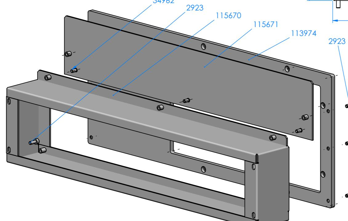
Vor der Komplettmontage muss die Rückwand ( RWA ) mit der Schnittstelle ( SST ) verschraubt werden.
