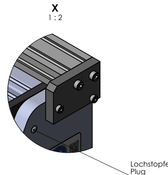
Offene Bohrungen müssen mit 47523 (Lochstopfen) geschlossen werden.
