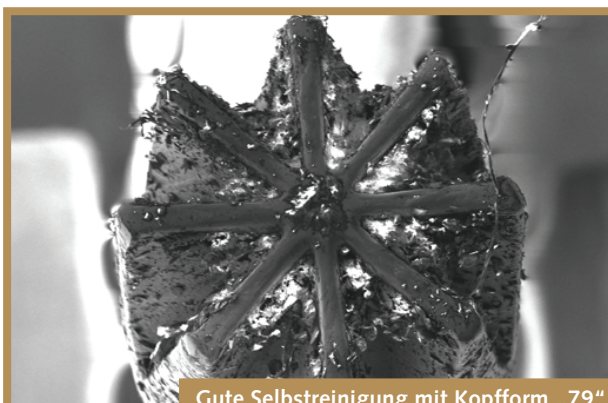
Gute Selbstreinigung mit Kopfform „79“ Kontaktierungen: 200.000
