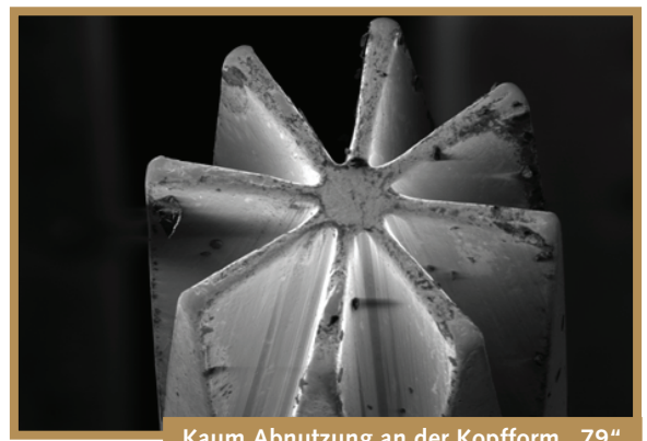
Kaum Abnutzung an der Kopfform „79“ Kontaktierungen: 200.000 (gereinigt)
