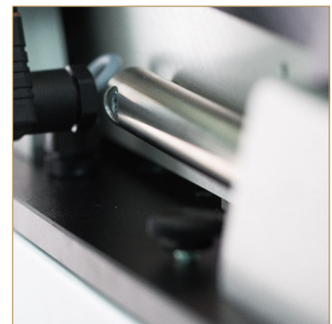
Bremszylinder des elektrisch betriebenen Selbstöffners
