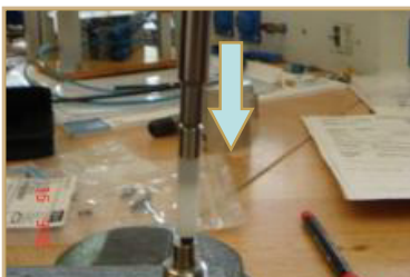
7. Senkrecht Einpressen der Teile (z.B. mit Setzwerkzeug), bis Gleitlager bündig mit Markierkopf ist. Nach Möglichkeit den Markierkopf festhalten/festklemmen, um axiale Belastung auf den Getriebemotor zu vermeiden!
