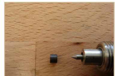
6. Einsetzen des Gleitlagers (Fase voraus)
