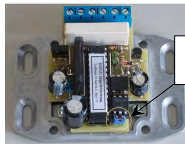
Jumper für getakteten Betrieb
