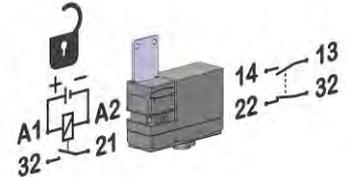
Durch Spannung entriegelt
