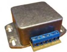
Die beiden Pole des Magneten werden an den entsprechend beschrifteten Klemmen angeschlossen. An „DCin“ wird die Versorgungsspannung angeschlossen (Polung beliebig). Der Magnet wird bei angelegter Spannung aktiv.
